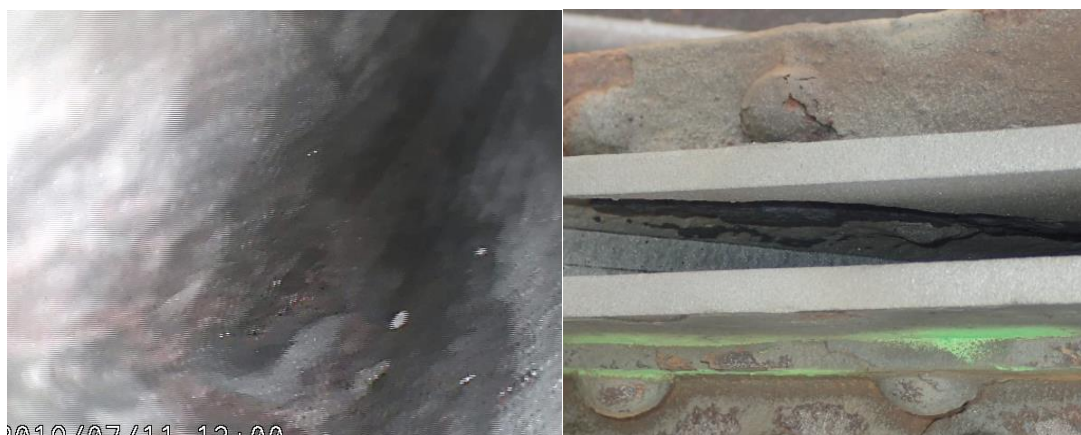
Obr. 37 Zvolené zkušební místo č.7 – po tryskání pomocí křemičitého písku (fotografie pořízené pomocí průmyslového videoskopu IPLEX G Lite)
