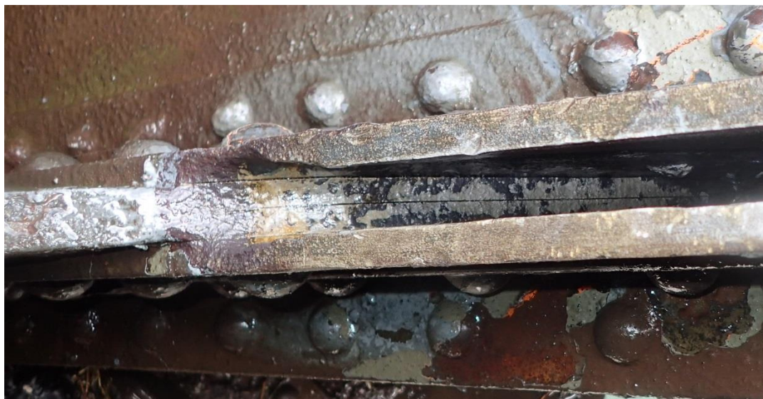
Obr. 17 Zvolené zkušební místo č.2 – Zleva: Po tryskání
