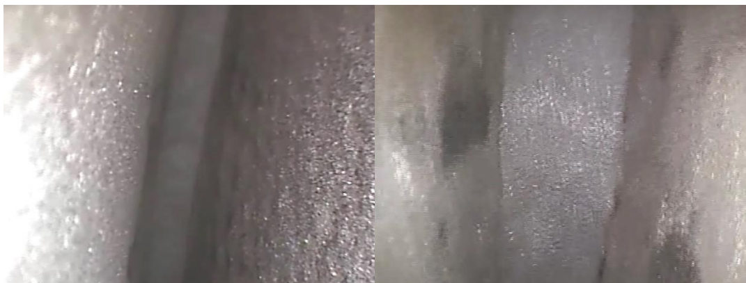
Obr. 45 Zvolené zkušební místo č.9 – po tryskání pomocí ocelového abraziva
