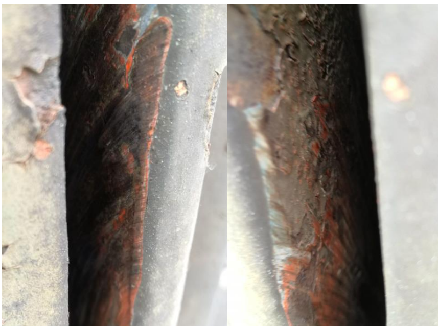
Obr. 53 Zvolené zkušební místo č.25 – Mechanická předúprava pomocí řezného kotouče – po aplikaci
