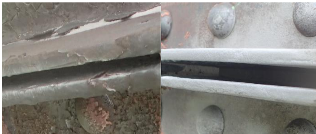
Obr. 31 Zvolené zkušební místo č.5 – Vlevo: před tryskáním, vpravo: po tryskání pomocí křemičitého písku
