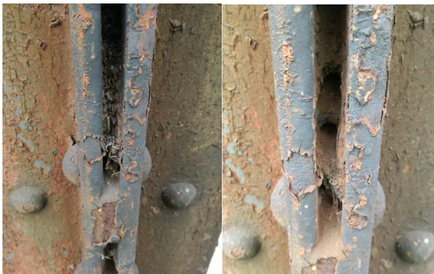
Obr. 50 Zvolené zkušební místo č.23 – Mechanický předúprava štěrbin pomocí vrtacího kladiva a vrtáku do kovu – po provedení čištění
