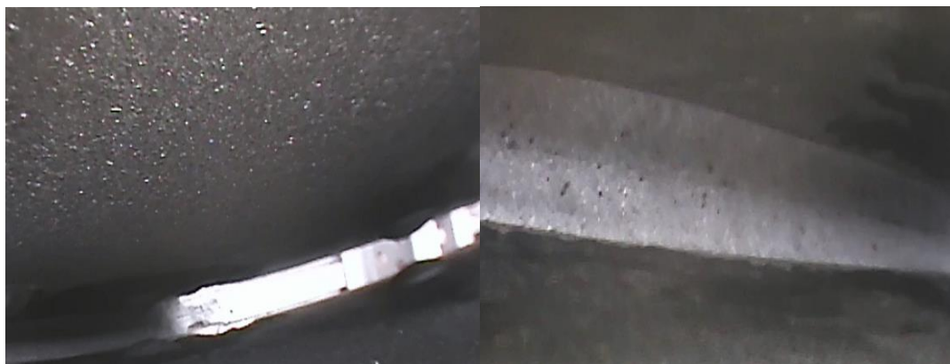
Obr. 47 Zvolené zkušební místo č.11 – Vlevo: po tryskání pomocí ocelového abraziva
