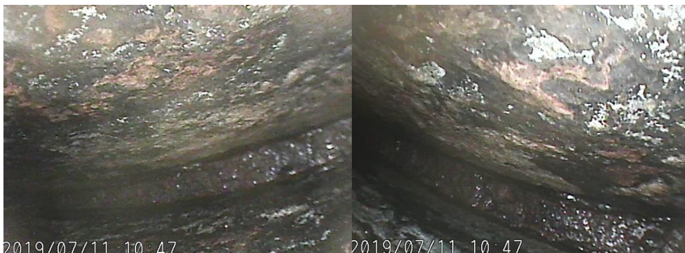
Obr. 23 Zvolené zkušební místo č.3 – Po tryskání, fotografie pořízené pomocí průmyslového videoskopu IPLEX G Lite
