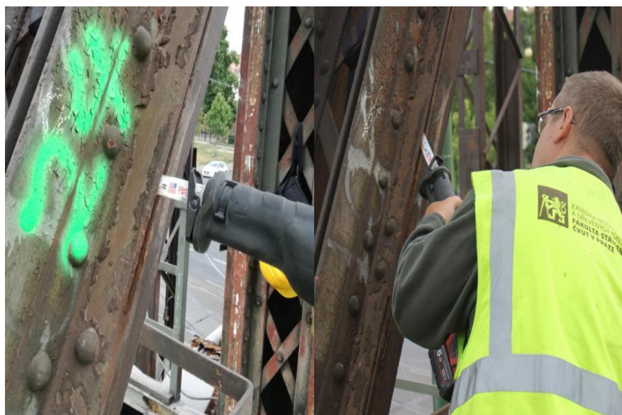
Obr. 51 Zvolené zkušební místo č.24 – Mechanický předúprava protažením štěrbin pomocí pily ocasky
