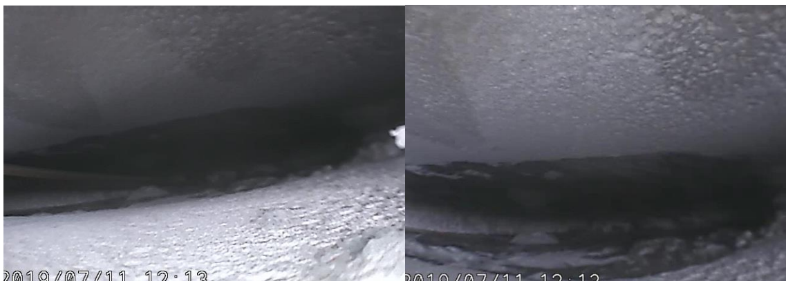
Obr. 34 Zvolené zkušební místo č.6 – po tryskání (fotografie pořízené pomocí průmyslového videoskopu IPLEX G Lite)
