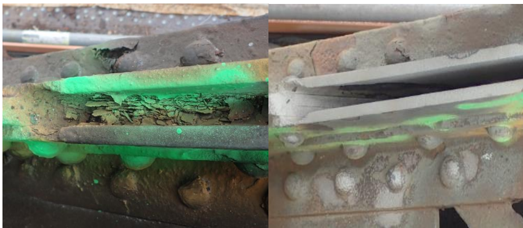
Obr. 46 Zvolené zkušební místo č.11 – Vlevo: před tryskáním, vpravo: po tryskání pomocí ocelového abraziva
