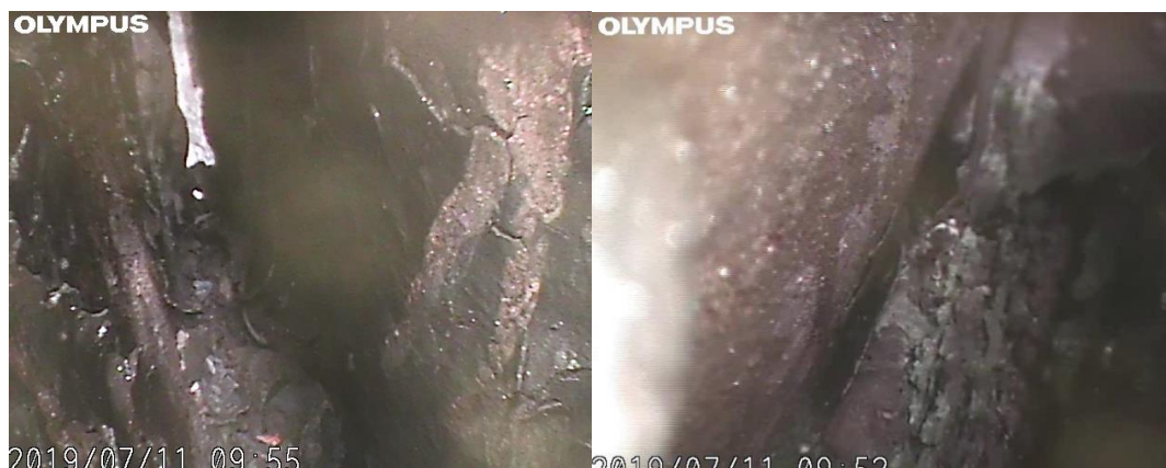
Obr. 13 Zvolené zkušební místo č. 1 – po tryskání, fotografie pořízené pomocí průmyslového videoskopu IPLEX G Lite
