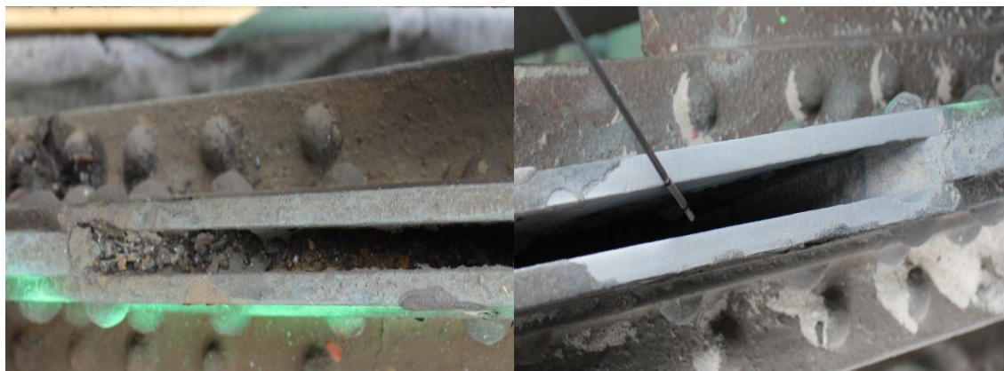
Obr. 33 Zvolené zkušební místo č.6 – Vlevo: před tryskáním, vpravo: po tryskání pomocí křemičitého písku
