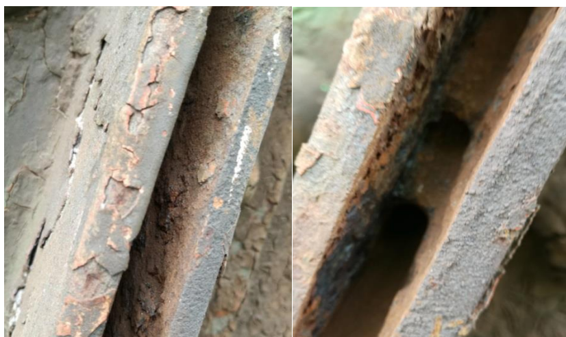
Obr. 49 Zvolené zkušební místo č.23 – Mechanický předúprava štěrbin pomocí vrtacího kladiva a vrtáku do kovu – po provedení čištění
