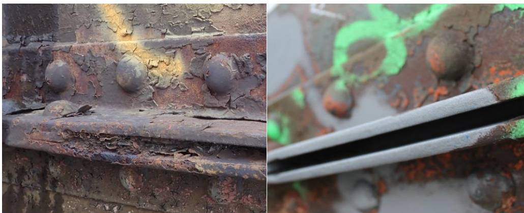
Obr. 38 Zvolené zkušební místo č.8 – Vlevo: před tryskáním, vpravo: po tryskání pomocí křemičitého písku
