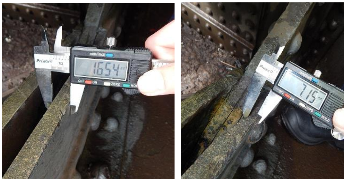
Obr. 19 Porovnání rozdílných tloušťek dolního profilu neprůběžné štěrbiny (II) mezi profily po odstranění korozních produktů a úsad
