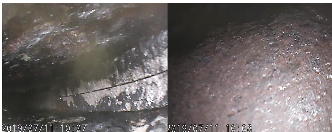
Obr. 18 Zvolené zkušební místo č.2 – po tryskání, fotografie pořízené pomocí průmyslového videoskopu IPLEX G Lite
