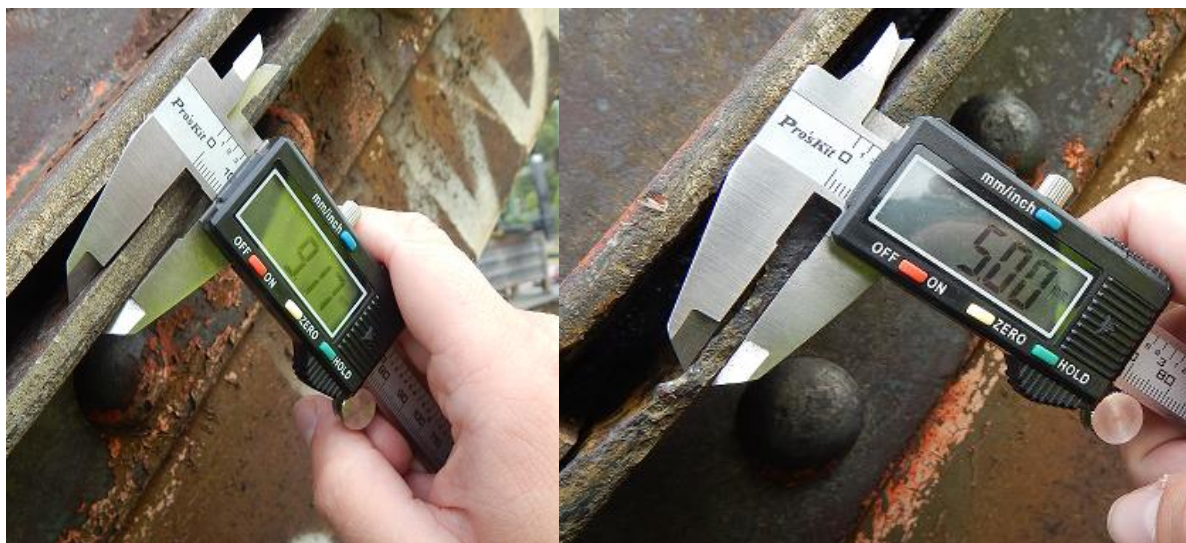
Obr. 14 Porovnání rozdílných tloušťek dolního profilu neprůběžné štěrby mezi profily po odstranění korozních produktů a úsad
